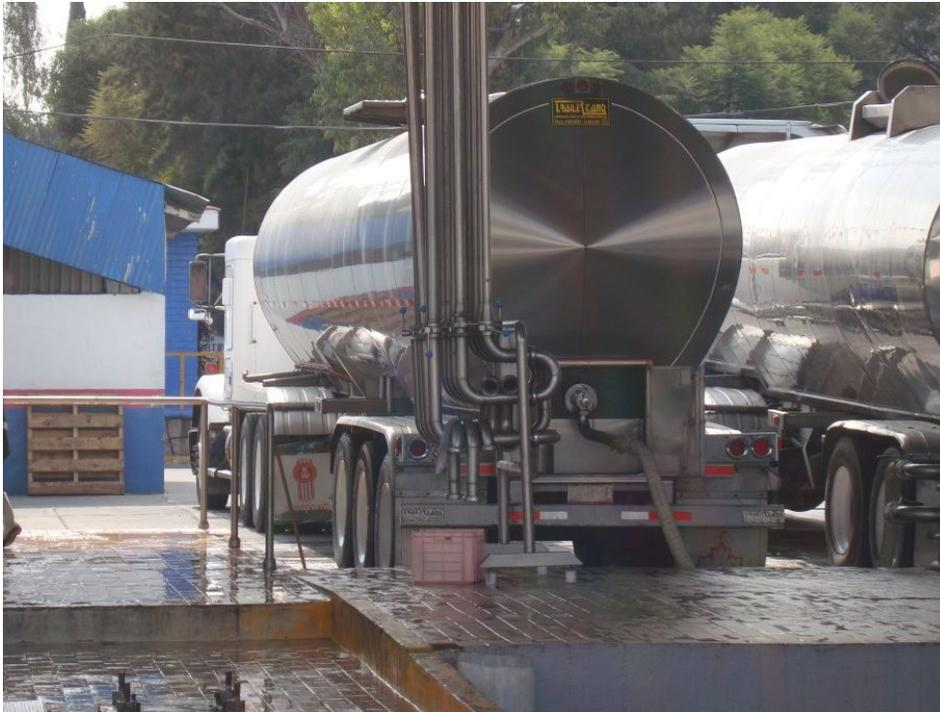
La descarga se realiza mediante bombas, en virtud de que la planta tiene la capacidad de procesar la leche, se debe tomar en cuenta la importancia de que el proceso sea ágil en virtud de que el tiempo de descomposición de la leche no es muy prolongado, por lo que a fin de garantizar la calidad se busca dar celeridad a las acciones para la recepción y procesamiento de dicho producto.
